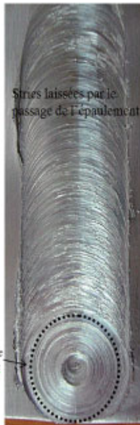
Figure. 4 : Soudage de la tôle 2024-T3 avec une vitesse de rotation V_r = 2800 tr/mn, vitesse d'avance V_a = 10 mm/mn, pion fileté (pas = 1.25) à 03 gorges et une inclinaison de l'axe de l'outil de 2^\circ .
